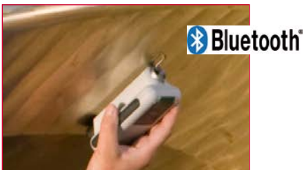
Messen einer Schiffsschraube mit dem Vorschubgerät MarSurf RD 18 und dem Tastsystem PHT 6-350, ohne Kabel
